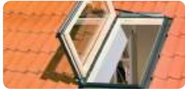
Окно FW\_U3 служит для комфорtnого и безопасного выхода на крышу. Может использоваться как аварийный выход. Имеет боковое открывание на угол до 90°. В модели FWP U3 предусмотрен универсальный способ открывания: петли можно установить во время монтажа на любую сторону, что позволит окну открываться как вправо, так и влево.
