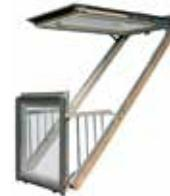
Двусторчатое мансардное окно, верхняя створка которого может открываться независимо от нижней, выполняя функции обычного окна для крыши, а при открывании нижней створки образуется дополнительное пространство, и окно трансформируется в балкон.
